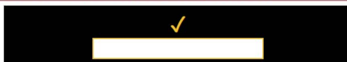
Figura 08. Captura de tela com exemplo de teste de contraste entre primeiro e segundo plano com as cores amarelo e preto, atingindo uma taxa de contraste adequada (12,5:1).
