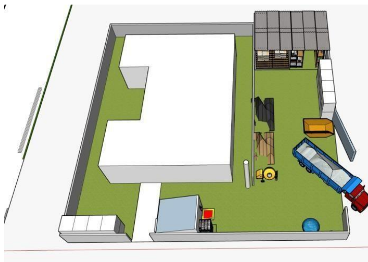
Figura 7 - Proposta de layout de canteiro de obras. Fonte: Autores, 2024.
