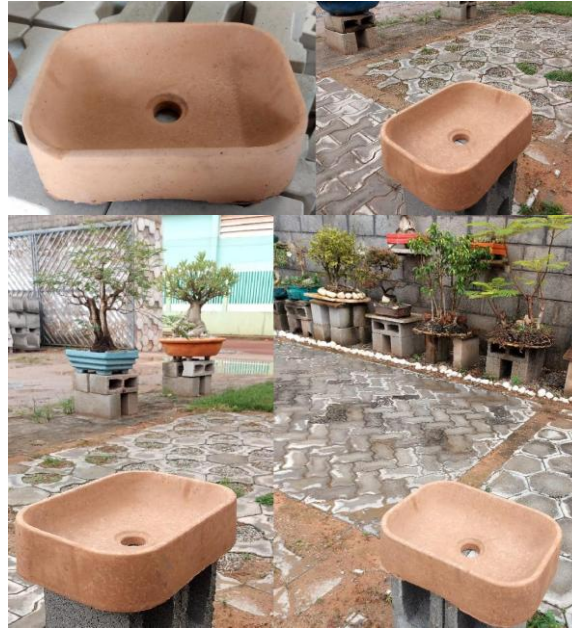
Figura 4 – Cuba arredondada de 4,2 litros, com dimensões de 38 x 28 cm Fonte: Autores, 2024.
