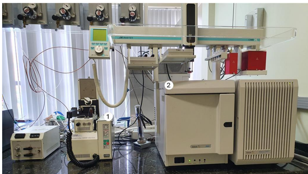
Figura 1 – Sistema de pirólise analítica conectada a cromatografia a gás com detecção por espectrometria de massas (Py-GC/MS): 1 – pirolisador e 2 – GC/MS.
