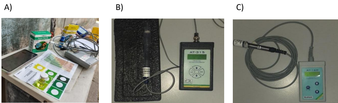
Figura 1: Kits colorimétrico (A), pHmetro digital (B), Oxímetro digital (C).
