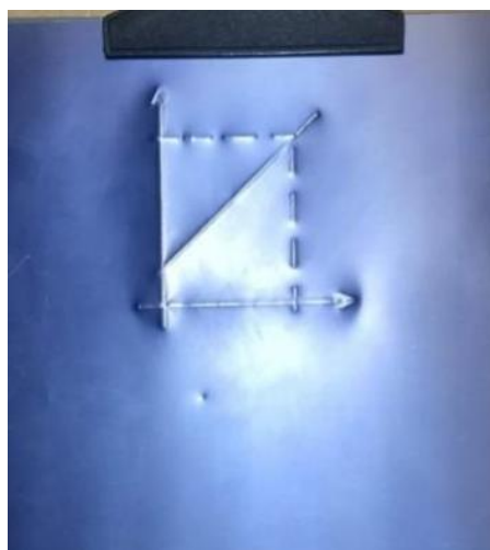
Figura 29 – Gráfico marcado em alto-relevo na placa de offset
