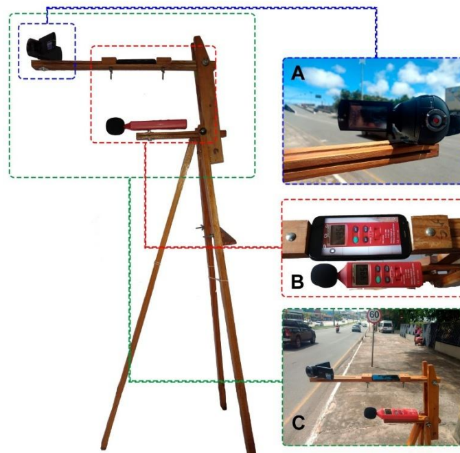
Figura 13 – Um possível sistema para suporte dos equipamentos. (A) Câmera de registro do Tráfego; (B) Suporte do celular e do medidor NPS; (C) exemplo de como o sistema deve ficar durante a coleta de dados
