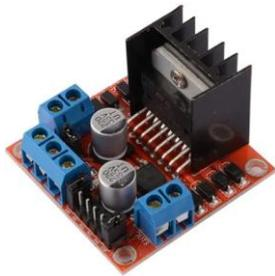
Placa L298n Motor drivecontrolador - ponte H
