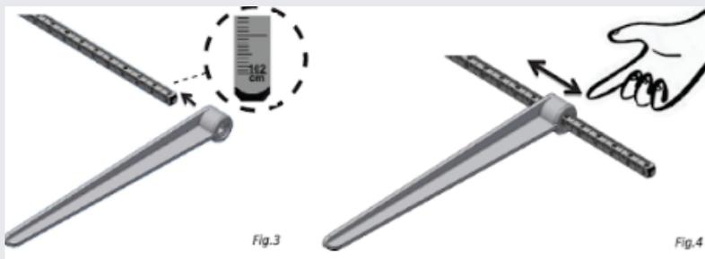
**Figura 7**- Montagem do braço móvel do infantômetro
