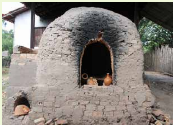
Figura 23 – Forno de queima cerâmica, com objetos já queimados em seu interior. Foto: Arkley Bandeira, 2017.
