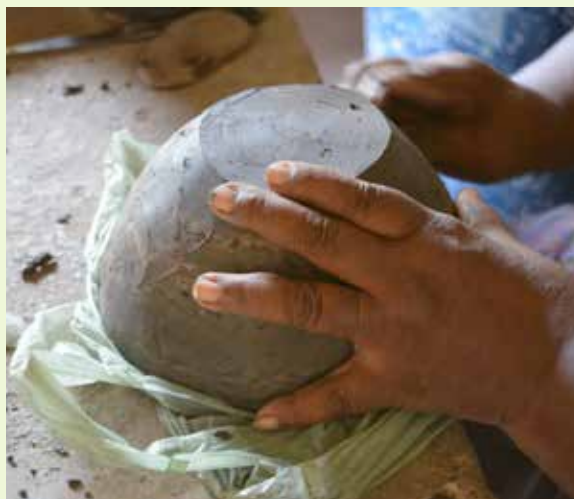
Figura 20 – Processo de alisamento para junção dos roletes e retirada do excesso da argila. Foto: Arkley Bandeira, 2017.
