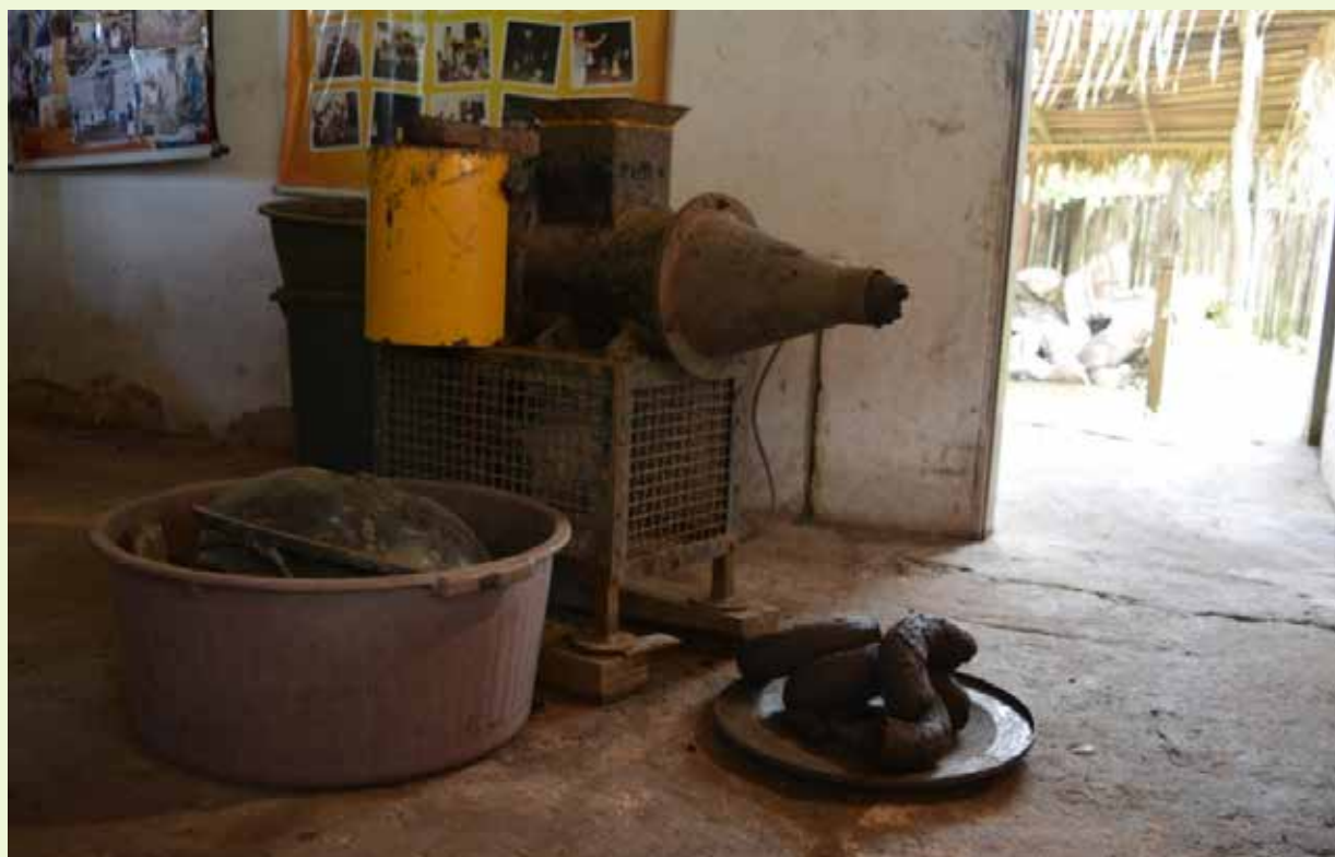
Figura 16 – Equipamento denominado de maromba que deixa a argila pronta para o uso. Foto: Arkley Bandeira, 2018.
