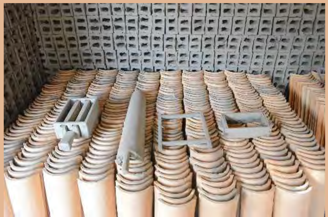
Formas para confecção de telhas, lajotas e tijolos na oficina de Zé Elias. Foto Bandeira (2021)
