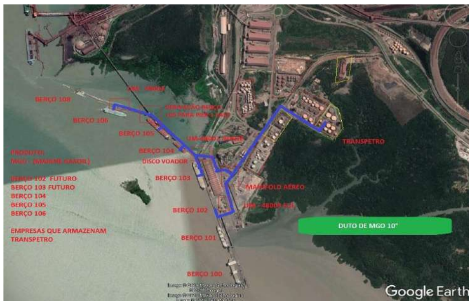
Figura 8. Tubulação de carga e descarga de MGO para companhias distribuidoras
