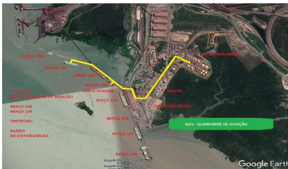
Figura 11. Tubulação de carga e descarga de QAV – Querosene de Aviação
