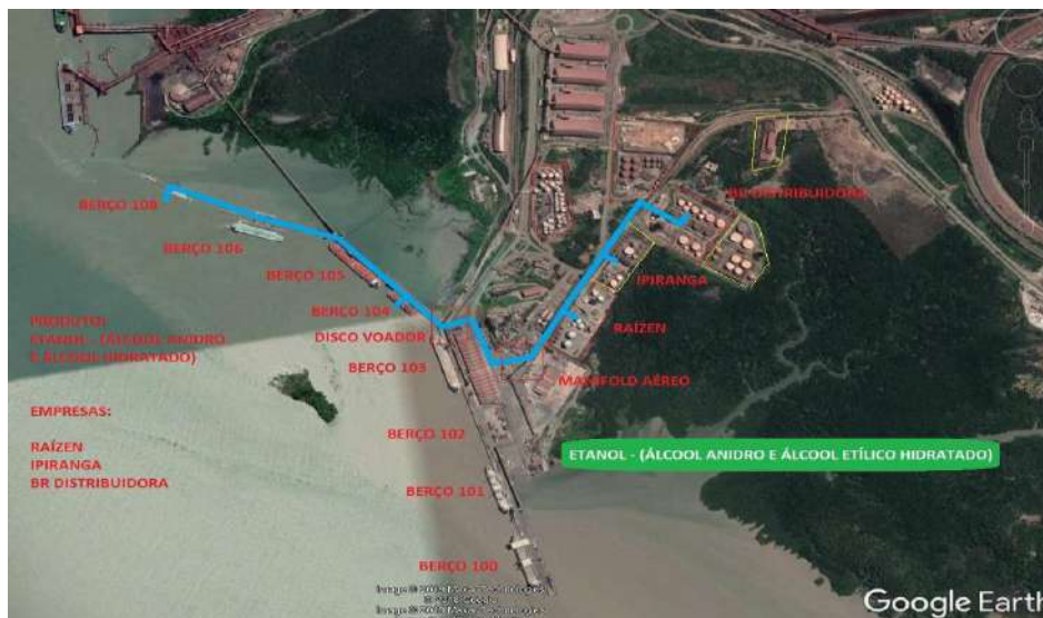
Figura 12. Tubulação de carga e descarga de ETANOL para as Companhias distribuidoras Raízen, Ipiranga e BR Distribuidora
