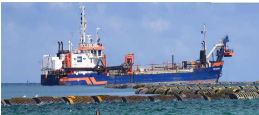
Fonte: Van Oord, 2020 - Draga tipo Hopper.
