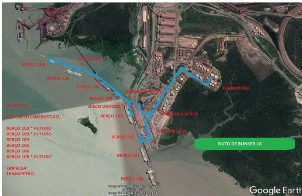
Figura 9. Tubulação de carga e descarga de BPF (Óleo combustível) para companhias distribuidoras
