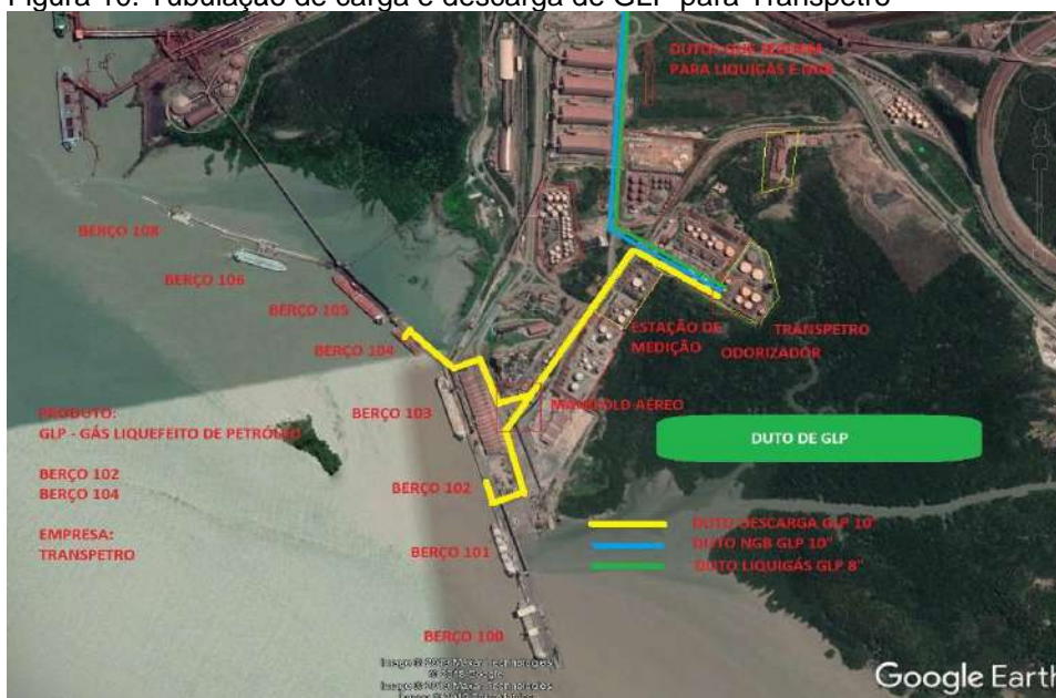
Figura 10. Tubulação de carga e descarga de GLP para Transpetro
