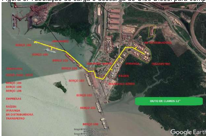
Figura 6. Tubulação de carga e descarga de Óleo Diesel para companhias distribuidoras
