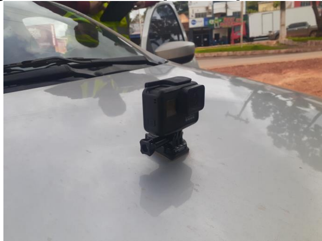
Figura 05: GoPro Hero 7 acoplada no capô de um veículo.
