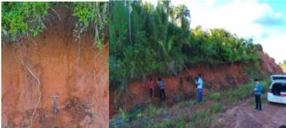
Figura 2: Erosão do tipo ravina encontrada no Ponto de coleta de amostras de solos
