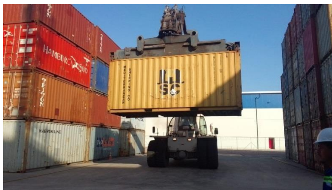
Figura 04 – REACH STACKER transportando contêiner de 20' IMO para área adequada. Fonte: Arquivo COPLA PROJETOS/EMAP, 2022.
