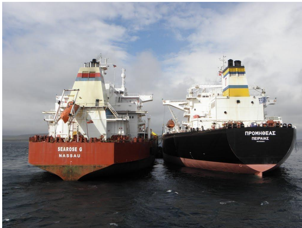
Figura 04 - Operação STS em movimento ( underway )
