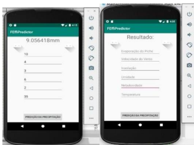
Figura 2 – Aplicativo android de uma RNA com 100 Epoch e 400 neurônios
