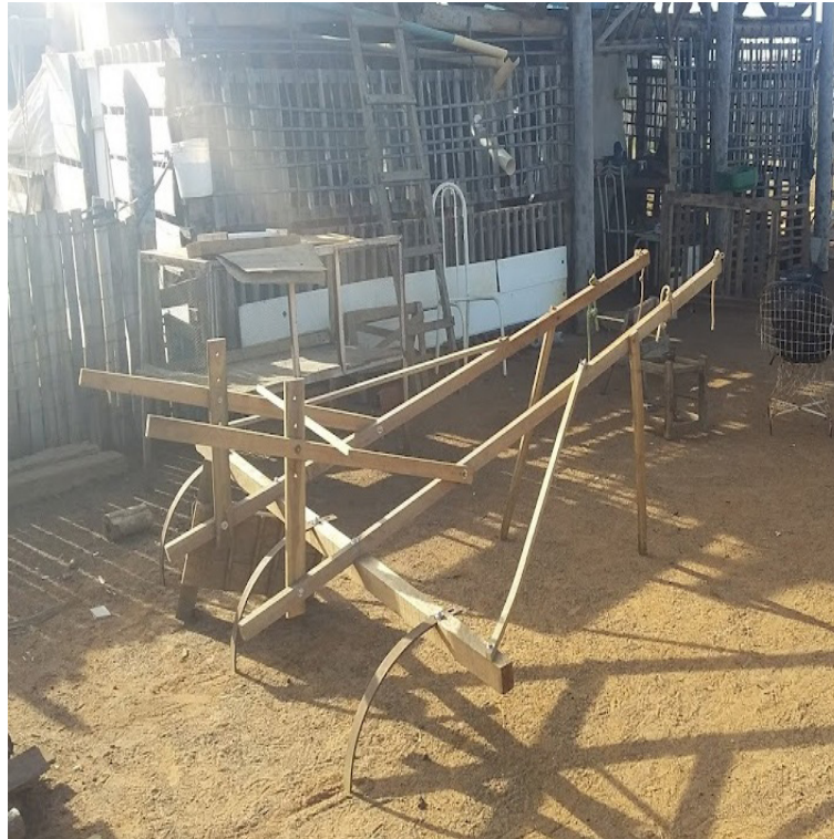
FOTO 1 – Ferramenta de arar a terra produzida com base na TS.
